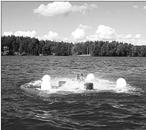
Järven länsipään Waterix-ilmastin toiminnassa. Kuva O-P. Mäki/ympäristötoimisto.
